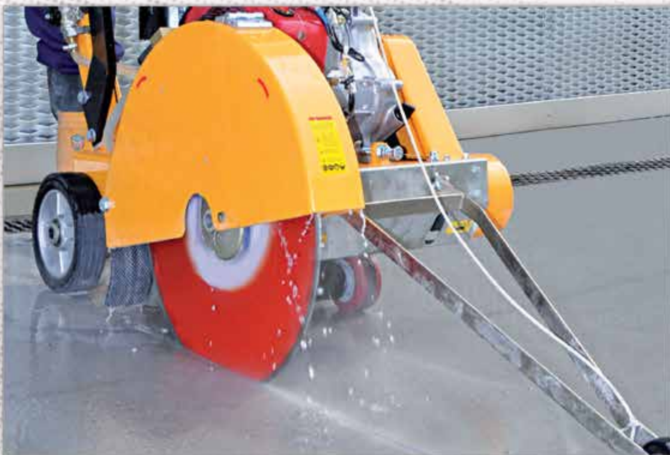
TAGLIAGIUNTI/ASFALTO - JOINT CUTTING MACHINE
