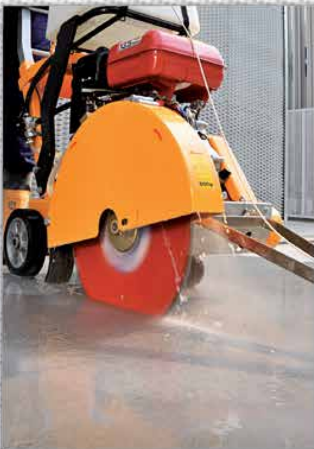
TAGLIAGIUNTI/ASFALTO - JOINT CUTTING MACHINE
