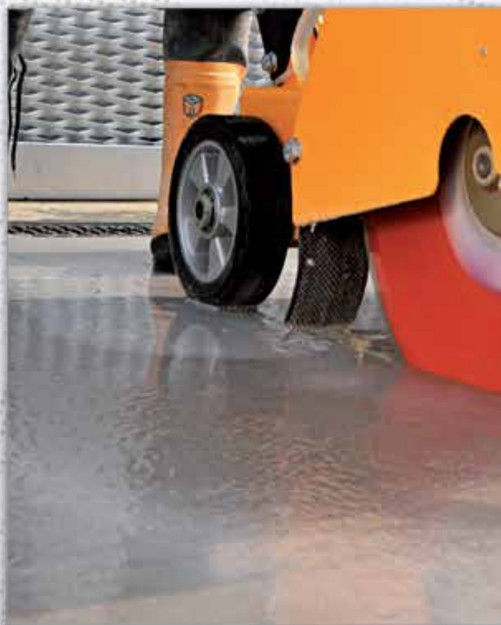
TAGLIAGIUNTI/ASFALTO - JOINT CUTTING MACHINE
